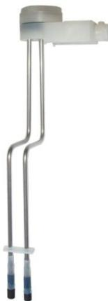
Trockenheizschutz/Niveau-Stabelektroden mit PVDF-Anschlusskopf und abgewinkelten PTFE-ummantelten PTFE/Graphit-Elektroden. Lieferbar aus Edelstahl, Titan, Hastelloy und PTFE/Graphit
