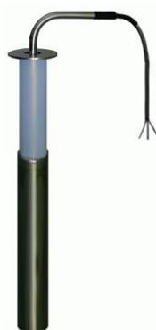
Wasserdichter Metall-Badwärmer mit PTFE-Ummantelung über der minimalen Eintauchtiefe. Erforderlich wenn an der Übergangsstelle von Flüssigkeit zur Luft Lochfraß verhindert werden soll. Lieferbar bei Edelstahl, Titan und Stahl-Tauchrohrmantel.
