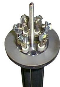
Rundflansch-Rohrheizkörper mit eingedrehter Dichtungsnut. Lieferbar mit Schraubklemmen oder Anschlusslitzern (Glasseidenummantelt oder Siliconummantelt). Aus Werkstoff Edelstahl, und Titan auch mit Überwachungsfühler z.B. Pt 100 oder PTC-Fühler
