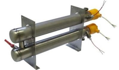
Durchlauferhitzer aus Edelstahl oder Titan mit Schlauchanschluss oder Gewindeanschluss G 1", 1 1/4", 1 1/2" mit Pt 100 Temperaturfühler für Temperaturregler, Temperaturbegrenzer.
