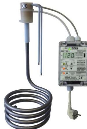
Titan-Heizstab Ø 10mm mit rundem PVDF-Anschlusskopf, spiralförmig gebogen. Mit aufgesetztem (austauschbar) Trockenheizschutz/Niveau-Elektroden und vollautomatischer Steuerung mit eingebautem Temperaturregler, Temperaturbegrenzer und Trockenheizschutz.
