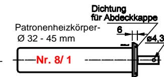
Rohrmantel-Ø 36 - 63,5 mm mit Anschraubflansch, Schutzleiterlasche und Klemmbügel, dadurch sicherer Schutzleiteranschluss, kein Herausrutschen der Patrone.
