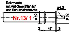
Rohrmantel-Ø 36 - 54 mm mit Gewindenippel G 1 1/2" = Rohr-Ø bis 42,4 mm, (G 2" = Rohr-Ø bis 54 mm), mit Schutzleiterlasche und Klemmbügel, dadurch sicherer Schutzleiteranschluss.
