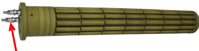
Patronenheizkörper mit Edelstahl-Gewindebolzen. An diesen sind die zwischen den Gewinde-Muttern verschraubten (verklebten) verdrehten Anschlussdrähte der Heizspirale zusätzlich verschweißt. Dies ergibt eine bessere Kontaktierung, löst Kontaktprobleme bei Vibration/Erschütterung usw. Auf Anfrage.
