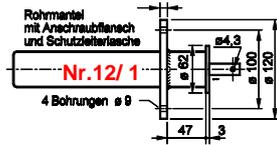
Rohrmantel-Ø 36 - 54 mm mit Anschweißflansch Ø 68, Schutzleiterlasche und Klemmbügel, dadurch sicherer Schutzleiteranschluss.
