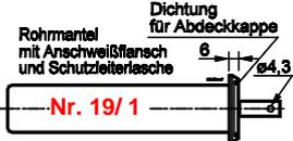
Rohrmantel-Ø 36 - 54 mm mit Anschweißflansch, Schutzleiterlasche und Klemmbügel, dadurch sicherer Schutzleiteranschluss.
