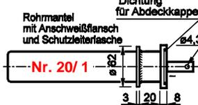
Rohrmantel-Ø 36 - 54 mm mit Gewindenippel G 1 1/2" = Rohr-Ø bis 42,4 mm, (G 2" = Rohr-Ø bis 54 mm), mit Schutzleiterlasche und Klemmbügel, dadurch sicherer Schutzleiteranschluss.
