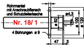
Dieser Typ ermöglicht kürzeste Abdeckungsmaße. Rohrmantel - Ø 36-54 mm mit Anschweißflansch, Schutzleiterlasche und Klemmbügel, dadurch sicherer Schutzleiteranschluss.
