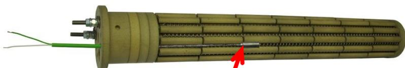
Patronenheizkörper mit Gewindebolzen (auch Litzenanschluss möglich) und eingebautem Temperaturfühler zum Überwachen der Temperatur oder zum Temperaturbegrenzen. Der Fühler kann in der beheizten Länge der Patrone gemäß Ihren Anforderungen montiert werden. In alle Patronen-Ø einbaubar. Auf Anfrage.
