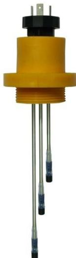
abgebildet: einschraubbare Trockenheizschutz/Niveau-Stabelektrode aus leitfähigem PTFE/Teflon Typ HTHP 3 Mit Hirschmannstecker Seite 92-93 Die Elektrodenlängen müssen bei der Bestellung angegeben werden.
