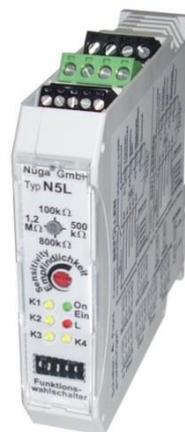
Niveaus-Schaltrelais N5L mit Leitungs-Überwachung. Damit kann die Elektrodenanschlussleitung auf Unterbrechung überwacht werden. Einstellempfindlichkeit 0 bis 1,2MΩ. 4 Empfindlichkeitsbereiche sind einstellbar. 4 unabhängige Schaltpunkte plus Masse-Referenzkontakt. Siehe Seite 48-57. Elektroden Seite 57
