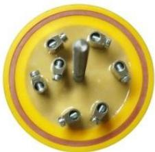
Einblick in einen geöffneten Trockenheizschutz / Niveau-Stabelektroden-Anschlusskopf. Ersichtlich sind die übersichtlich, montagefreundlich und leicht zugänglich angeordneten Klemmen.
