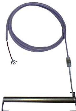
Tankheizkörper (Bodenheizung) mit flexibler (Ø 13mm) PTFE/ (Teflon) ummantelter Zuleitung. Tankhöhe bis ca. 15 Meter, mit großer Leistung (kW) lieferbar. Aus Edelstahl und Titan.
