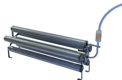
Tankheizkörper (Bodenheizung) mit flexibler (Ø 13mm) PTFE/ (Teflon) ummantelter Zuleitung. Tankhöhe bis ca. 15 Meter, mit großer Leistung (kW) lieferbar. Aus Edelstahl und Titan.
