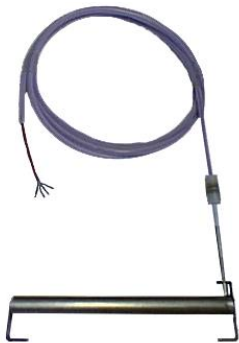
Tankheizkörper (Bodenheizung) mit flexibler (Ø 13mm) PTFE/ (Teflon) ummantelter Zuleitung. Tankhöhe bis ca. 15 Meter, mit großer Leistung (kW) lieferbar. Aus Edelstahl und Titan.
